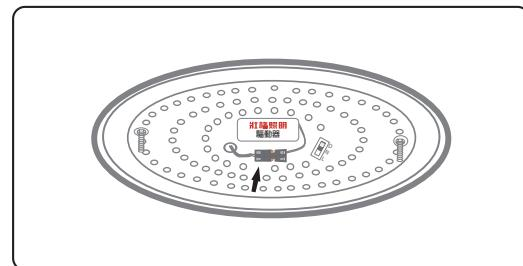
①請先分離【快接模組】連接處，並將【快接模組】從底盤出線孔取出
